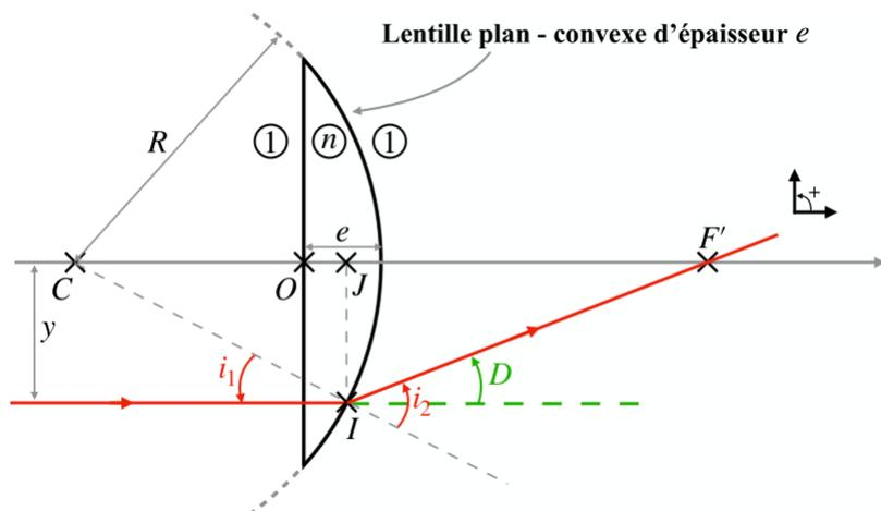
Ce rayon est ensuite réfracté vers l'axe optique, qu'il intersecte au point  $F'$ , le foyer image de la lentille. L'ensemble est représenté sur le schéma ci-dessus. On considérera, dans cette partie uniquement, que la lentille est réalisée dans un verre d'indice  $n = 1,5$ .
